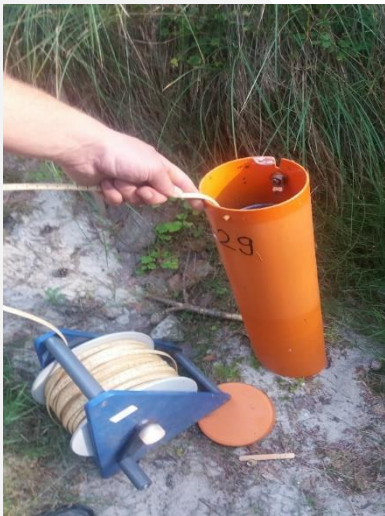
Pomiar głębokości występowania zwierciadła wód podziemnych
